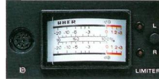
Dieses Doppelanzeigeninstrument erlaubt außerdem ein gleichzeitiges präzises Überwachen der beiden Stereo-Kanäle.
