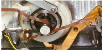
Das heißt: Das Band wird nicht mehr angepreßt, die Bandkanten werden geschont, es entstehen keine welligen Bandkanten mehr. Und - es werden keine Schmutzpartikel in die magnetische Schicht eingepreßt.
